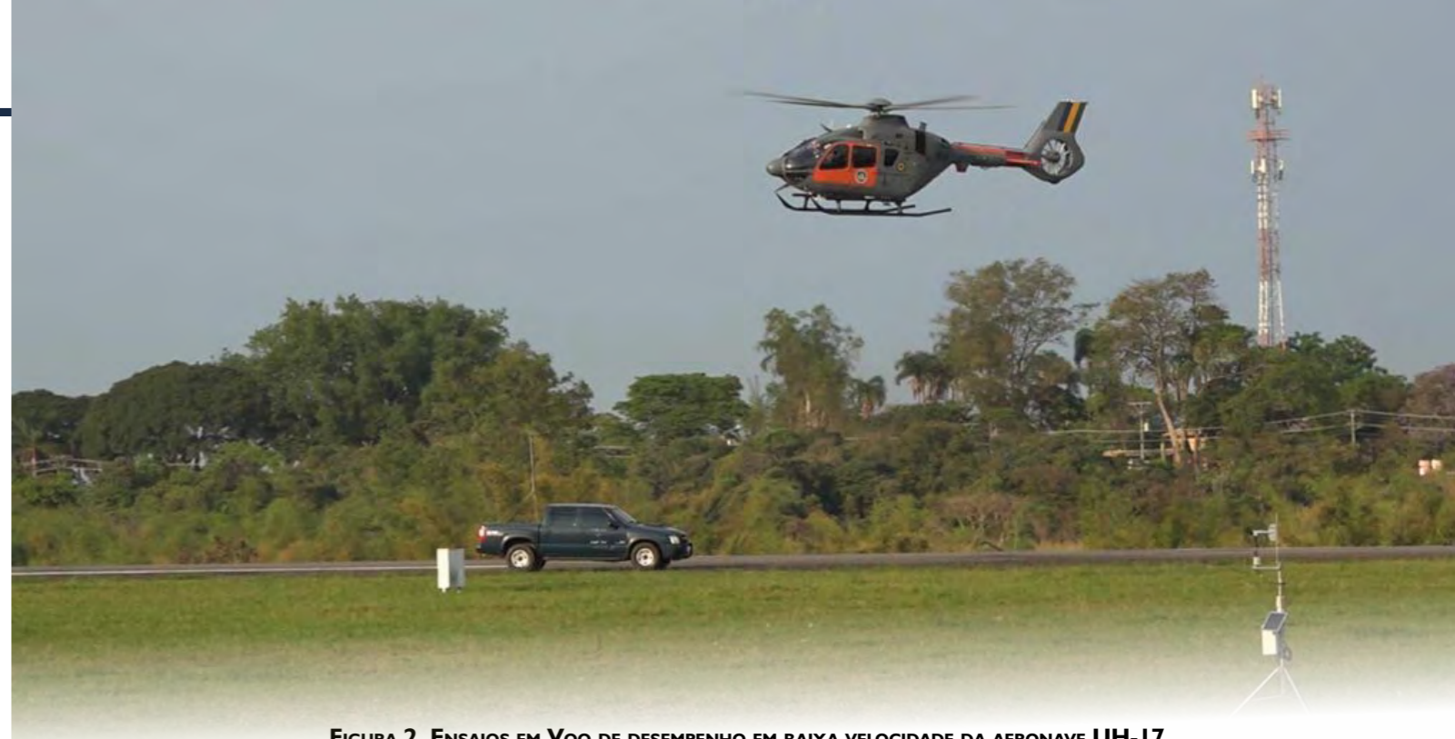
FIGURA 2. ENSAIOS EM VOO DE DESEMPENHO EM BAIXA VELOCIDADE DA AERONAVE UH-17
