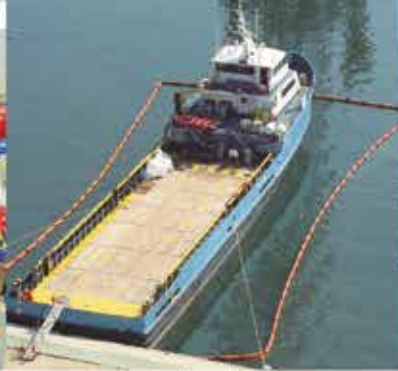
Cerco de contenção
