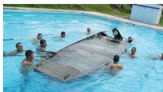
Figura 1: Teste de comprovação da flutuabilidade das ETT adaptadas com garrafas Pet Fonte: No Mar Online ( http://www.mar.mil.br/nomaronline/noticias/17102011/03.html )
