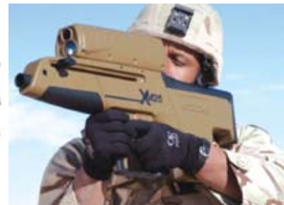
O XM-29 SABR, que seria parte do programa “Land Warrior”, congregava um fuzil derivado do HK G-36, um lançador de granadas de 25mm com munição inteligente, computador de tiro e lunetas especiais. Ao lado, o XM-25, que, como o XM-8, deriva do SABR. Notar o layout bullpup em um lançador de granadas, bem como a operação ambidestra.
