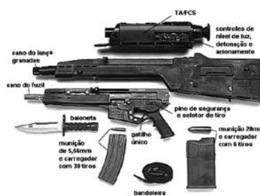
O XM-29 SABR, que seria parte do programa “Land Warrior”, congregava um fuzil derivado do HK G-36, um lançador de granadas de 25mm com munição inteligente, computador de tiro e lunetas especiais. Ao lado, o XM-25, que, como o XM-8, deriva do SABR. Notar o layout bullpup em um lançador de granadas, bem como a operação ambidestra.
