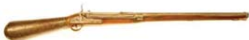
Rifle Girardoni, em que uma única carga de ar comprimido na coronha lhe dava capacidade para realizar até 30 disparos. Tinha um tubo-carregador lateral com capacidade para 22 esferas de chumbo de 11,75 mm. Consta que um atirador treinado podia disparar toda a capacidade da arma em apenas 1 minuto, até o alcance útil de 140 m.
