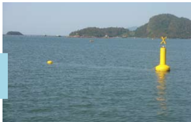
Boia amarrada com correntômetro Aquadopp, na Baía de Sepetiba.
