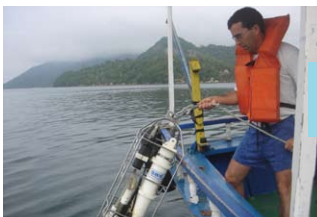
Coleta de dados hidrográficos, com CTD, na Baía de Sepetiba.
