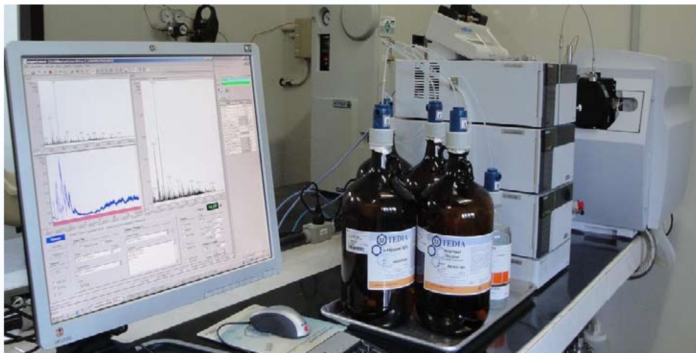
Sistema de Cromatografia Líquida acoplada a Espectrometro de Massas Sequencial (HPLC-MS-IONTRAP)
