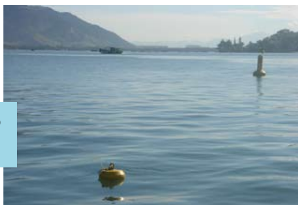
Boia fundeada com correntômetro Aquadopp, na Baía de Sepetiba.
