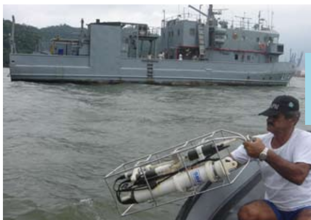
Coleta de dados hidrográficos na Baía de Sepetiba, com CTD, com apoio do AvPq "Aspirante Moura".
