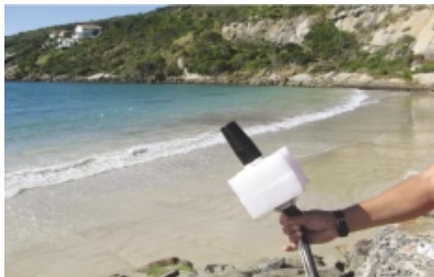
Figura 2 - Hidrofone ITC-6080C, em preparação para o lançamento na água.
