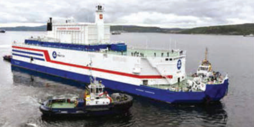
O KLT-40S, russo, uma usina flutuante com 2 reatores de 35 MW
