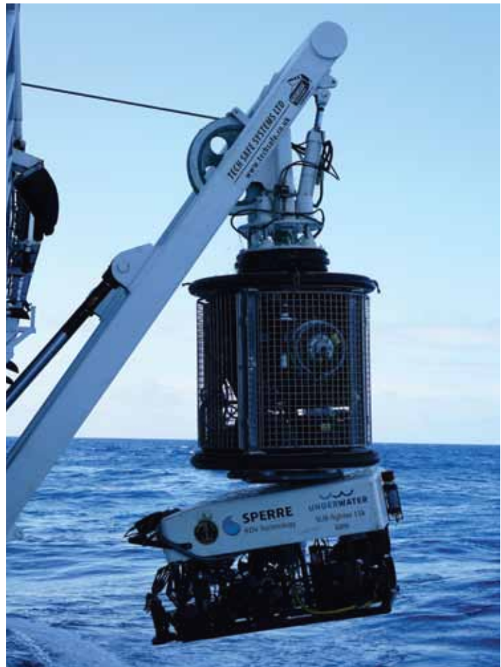
ROV (Veículo Submarino Operado Remotamente) do NPqHo "Vital de Oliveira" Equipamento que opera até 4.000 metros de profundidade
