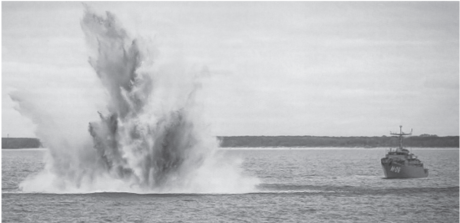
A explosão da mina marítima cria ondas de choque e “efeito bolha” que podem quebrar a quilha de um navio
