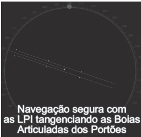
Figura 14 – Vista da tela do radar do navio, do alinhamento com portões duplos Fonte: NORB2D
