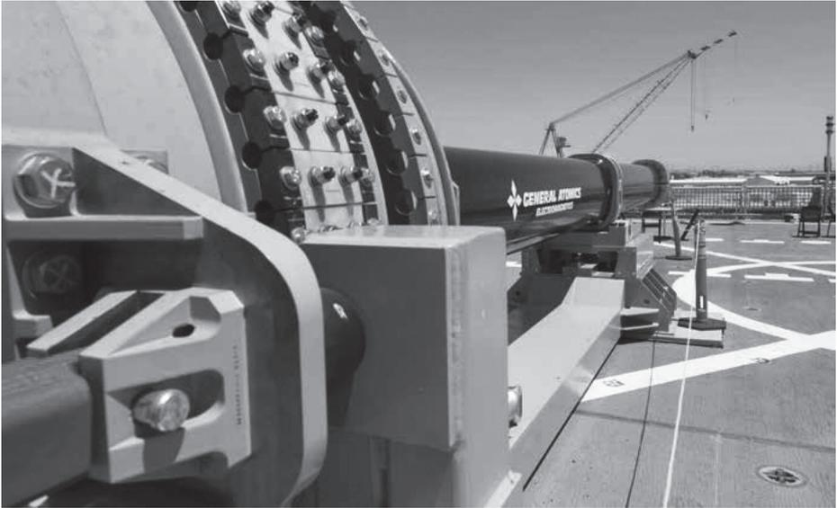
Protótipo de canhão eletromagnético desenvolvido pela General Atomics (Foto: U.S. Navy)
