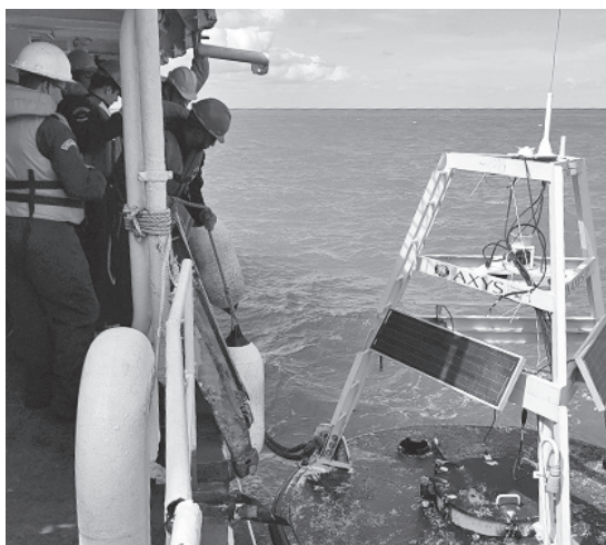
Militares do Sirius prepara a boia meteoceanográfica Rio Grande para ser rebocada
