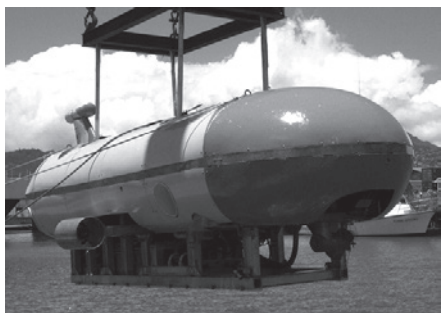
Figura 5 – Submarino não-tripulado semiautônomo produzido pela empresa Marine Autonomous System Engineering Fonte: Auvac (2018)
