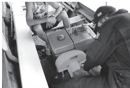
A cobertura de eixo em embarcação previne acidentes de escarpelamento
