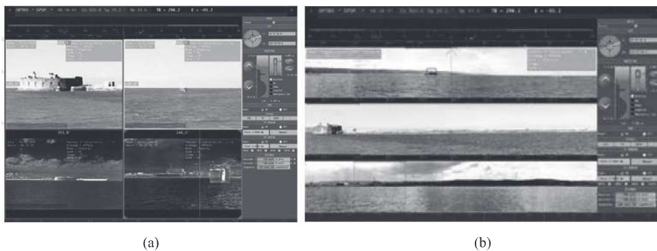
Figura 3: (a) Interface homem/máquina do mastro oprônico de busca, com as visadas normais das câmeras infravermelhas e HDTV e (b) Interface homem/máquina do SOM, com as visadas panorâmicas das câmeras infravermelhas e HDTV. Fonte: Site da empresa Sagem-Safran ( http://www.safran-electronics-defense.com/fr/file/download/d1755_series_30_som.pdf ), acesso em 29/10/2016
