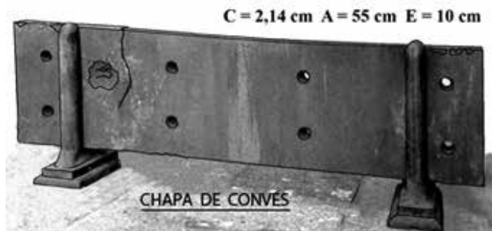
DIÂMETRO DO FURO, NA ENTRADA 5,6 CM DIÂMETRO DO FURO, NA SAÍDA 3,4 CM
