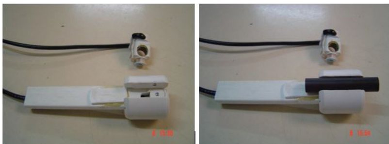
Figura 12 – Fotografia das duas sondas tipo “caneta”, em arranjo diferencial
