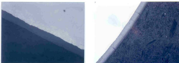
Figura 10 – Comparação de uma amostra com 110 horas de ensaio e aumento de 825 x, e outra com 888 horas de ensaio e aumento de 82,5 x
