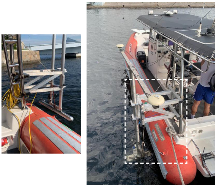
Figura 11 – No detalhe da figura, observa-se o sonar sidescan EdgeTech 4125 (BHMN) fixado na base, especificamente projetada para os testes com o VSNT-E
