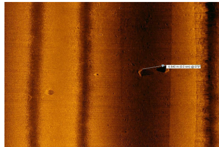
Figura 16 – Exemplo de medição de imprecisão do alvo sidescan , medido no software SonarWiz a partir do mosaico gerado
