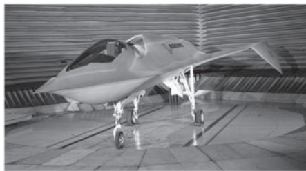
Figura 16 – Arranjo para medição da RCS de avião em câmara anecóica disponível na Boeing
