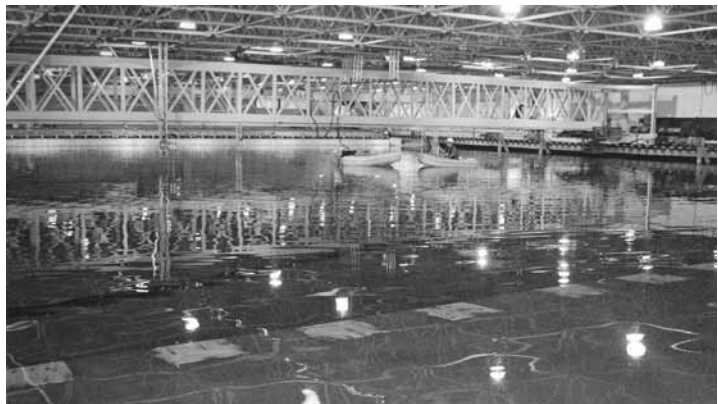
Tanque oceânico Coppe/UFRJ, onde as condições ambientais offshore podem ser reproduzidas
