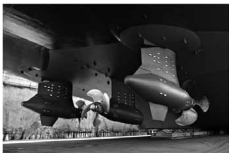
Propulsão AziPod do Navio de Cruzeiro MS Freedom of Seas
