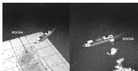
Figura 3 – Trecho da animação elaborada na EN, que reconstitui por meio de um modelo 3D de um navio de passageiros genérico, a cinemática do acidente, com base nos dados fornecidos pelo AIS (Automatic Identification System). (Vídeo disponível em http://youtu.be/j6HeYQXJHWo )
