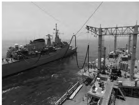
NT Marajó em fase III de adestramento – Transferência de óleo no mar pelo método Stream
